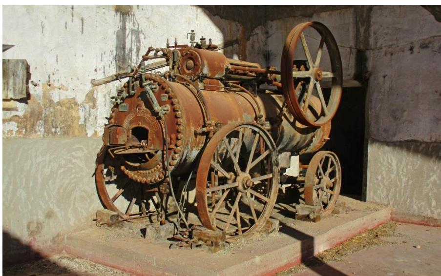
Imagen 9. Máquina de vapor de Heinrich Lanz (1903), usada para generar la fuerza motriz de la almazara, Tobarrillas
